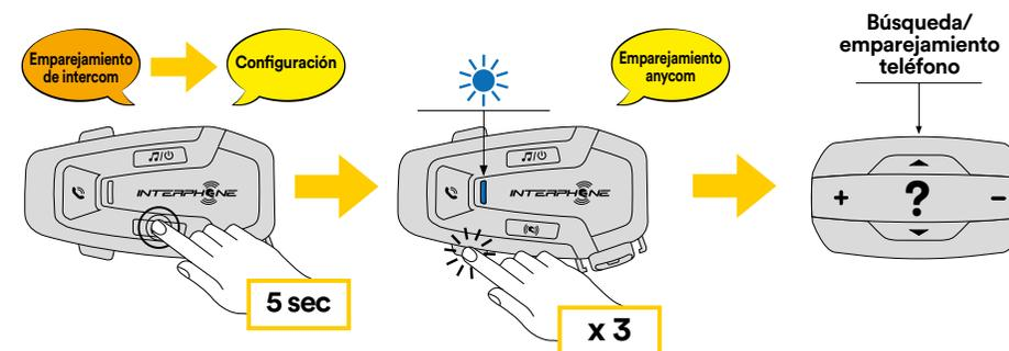
1. Con el U-COM 6R encendido, entre en el menú de configuración pulsando el botón INTERCOM durante 5 segundos. No suelte el botón antes de que el led se vuelva azul.
