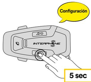
Con el U-COM 6R encendido, entre en el menú de configuración pulsando el botón INTERCOM durante 5 segundos. Asegúrese de no soltar el botón antes de que el LED se vuelva azul; escuchará el mensaje que confirma la activación del menú de configuración.
